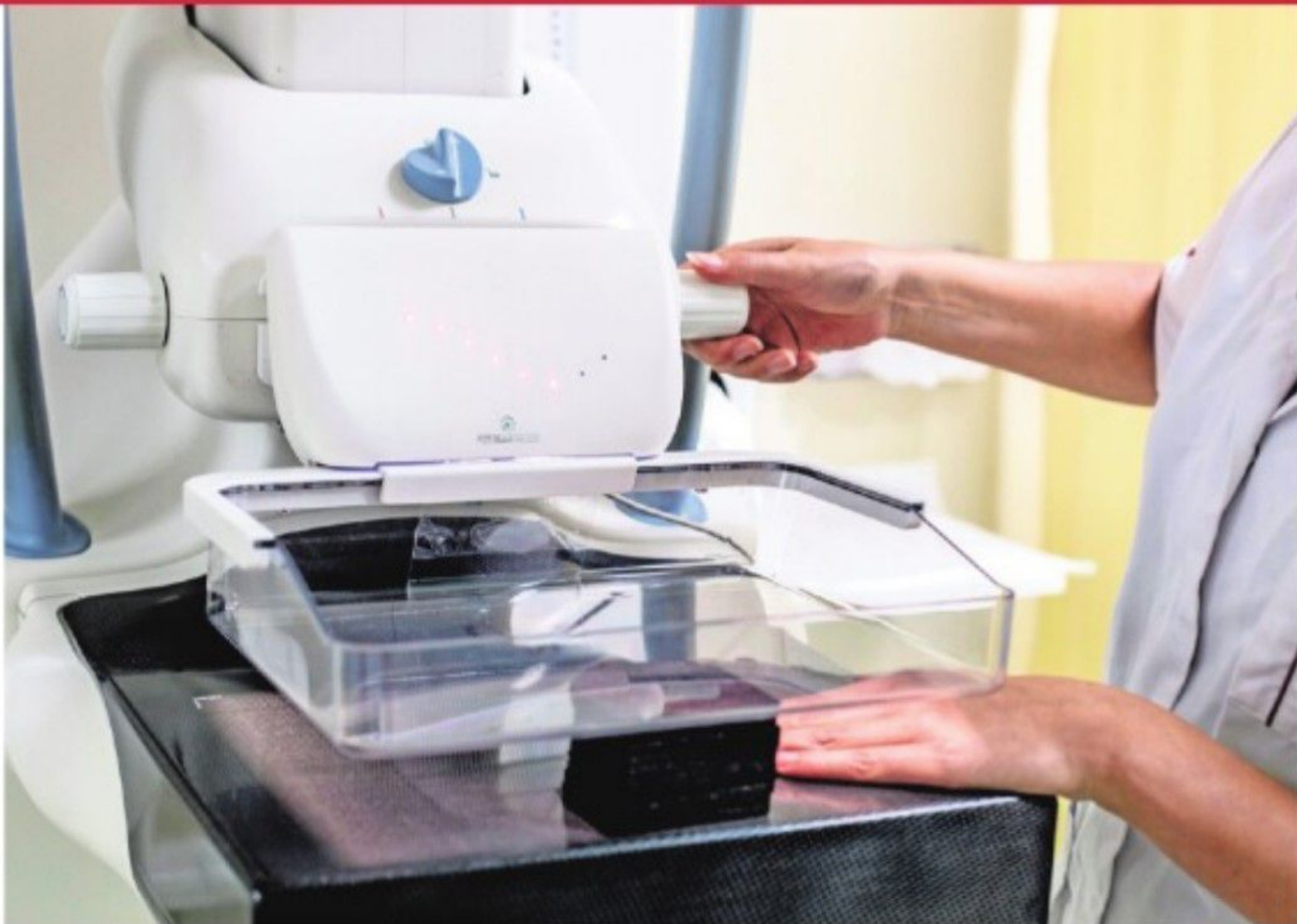
▲ De Sensitive Sigma Paddle (SSP) van Sigmascreening is een soort 'opzetstuk' voor de mammograaf, dat uitrekent hoeveel druk de aandrukplaat moet uitoefenen voor een goede foto. FOTO SIGMASCREENING
